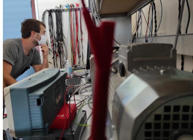
Figure 1 : Banc de test moteur synchrone à réluctance variable
